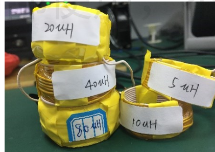
图 2.24 手工绕制的一组空心电感
