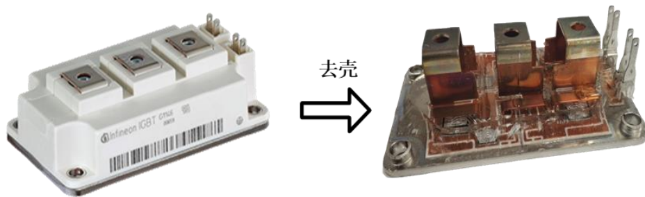
(a) 型号为 FF200R12KE4 的 IGBT 模块及其去壳后的照片
