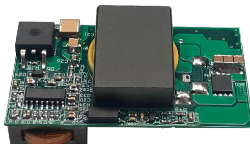
图 2.18 半桥 LLC 谐振变换器实验样机实物图
