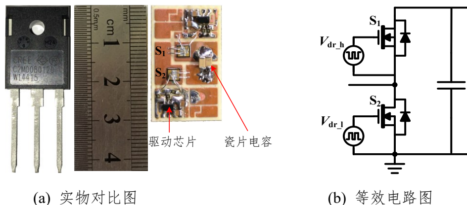
图 3.1 SiC MOSFET IPM 实物对比图与等效电路图
