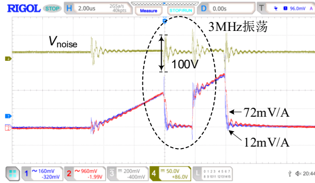
图 4.20 不同 TMR 测量灵敏度时的干扰以及 TMR 与被测导线间的电压噪声
