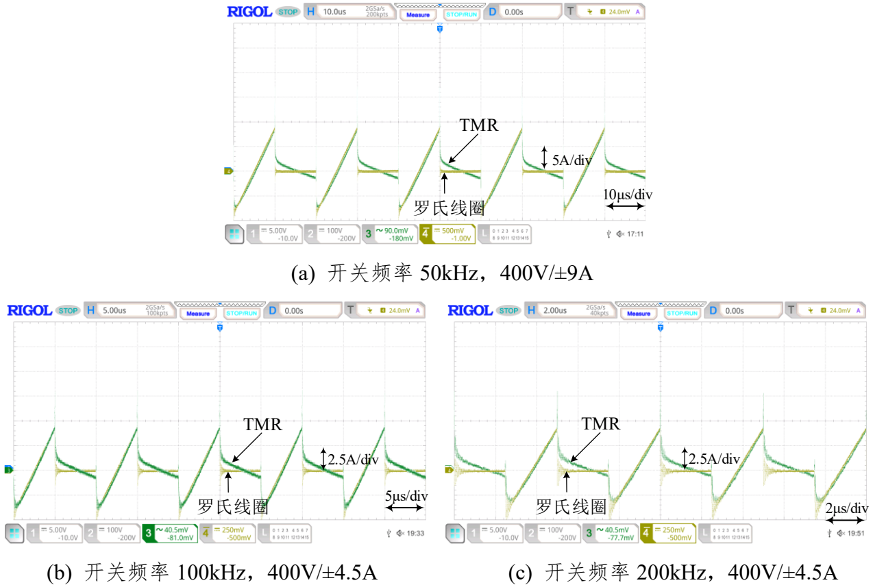
图 4.37 基于 SiC IPM 的 Buck 电路电流测量波形图
