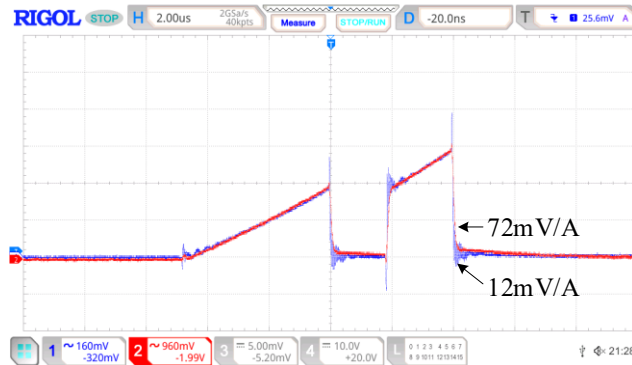
图 4.24 增加梳状屏蔽地后 TMR 测量波形
