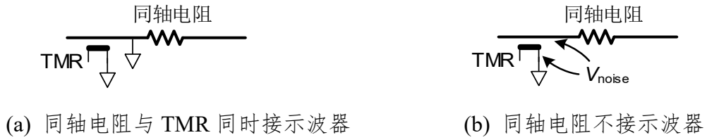
图 4.19 同轴电阻接与不接示波器时电流检测对比
