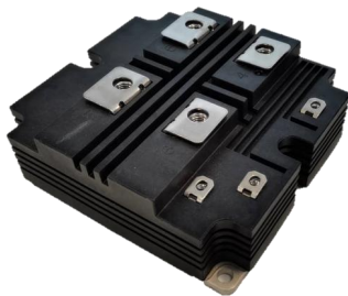
图 3-16 编号为 G40650004A 的 6.5kV/400A SiC 模块
