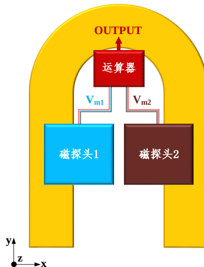
图 3.1 双端差分原理框图
