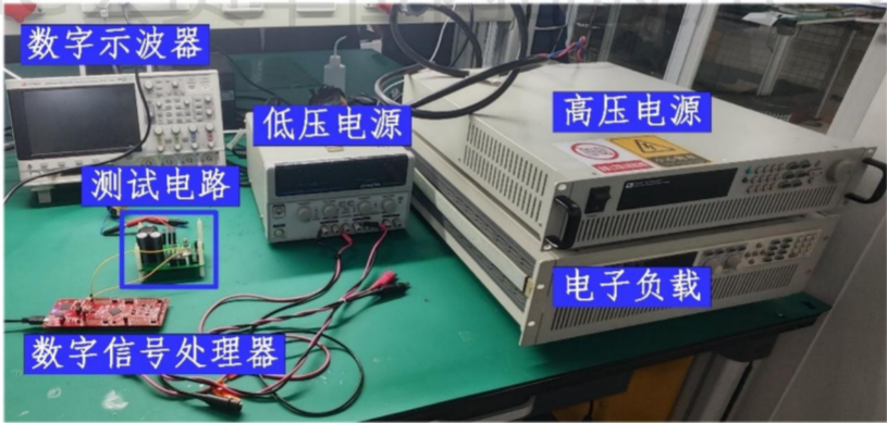
图 3-1 动态电阻测试平台
