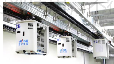
(b) 空中走行式无人搬运车 [10,11] OHT (Overhead Hoist Transport)
