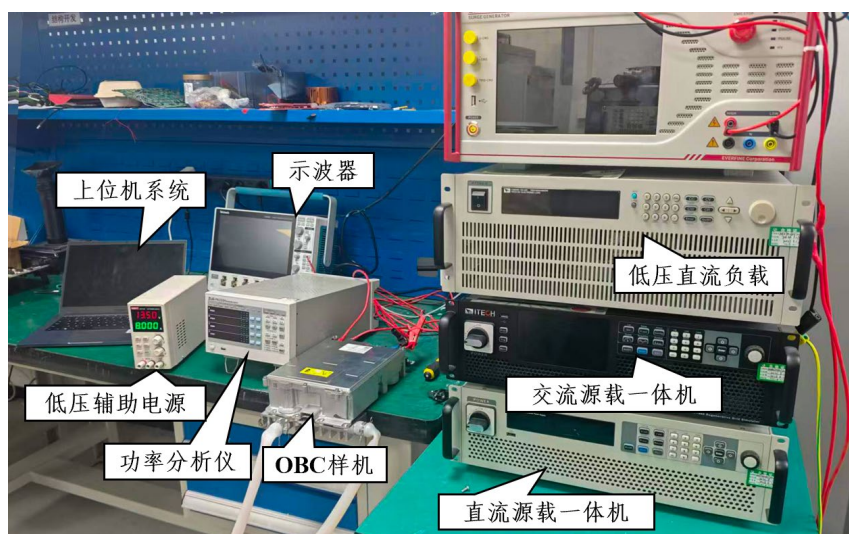
图 5-7 多移相 CLLC 电路实验测试平台
